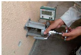
写真No.5 事前調査：既存塗膜の付着力強度試験を行っている
