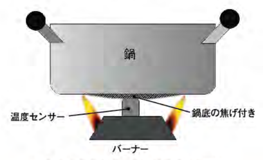
図4: 温度センサーの誤作動を招くケース
