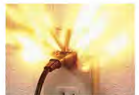
写真1: トラッキング現象の再現実験
