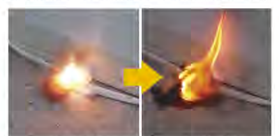
写真2: 電気コード出火の再現実験
